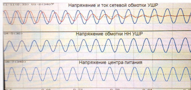
Рисунок 10 — Моделирование формы напряжения в диапазоне регулирования мощности при изменении схемы и включении ФВГ в состав комплектующих УШРт и УШРп
