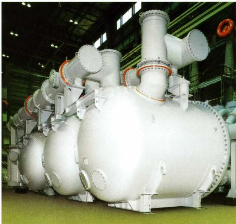
Полностью элегазовая подстанция 275 кВ (Тошиба, Япония)
