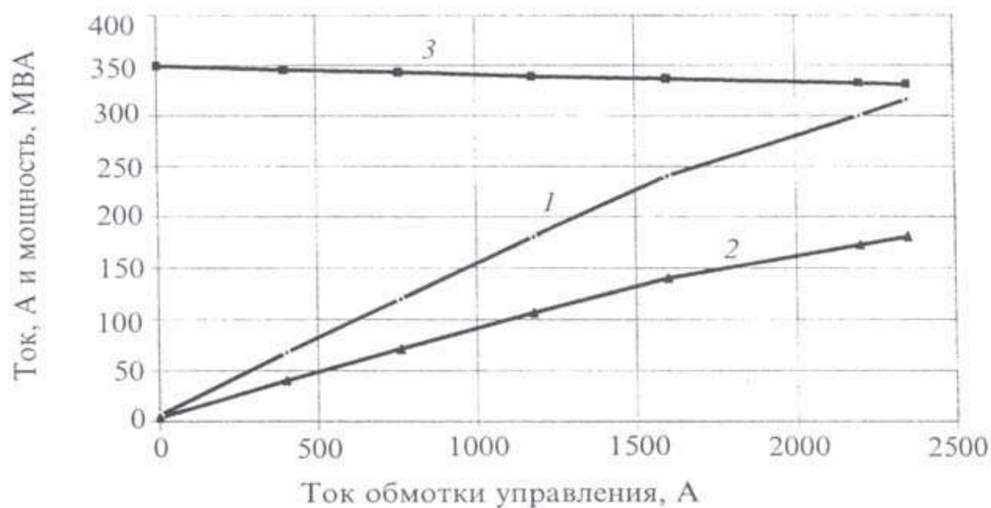
Рис. 2. Регулировочная характеристика РТУ-180000/330 — зависимость тока (1) и мощности (2) реактора от тока подмагничивания. Кривая 3 — напряжение сети при испытаниях
